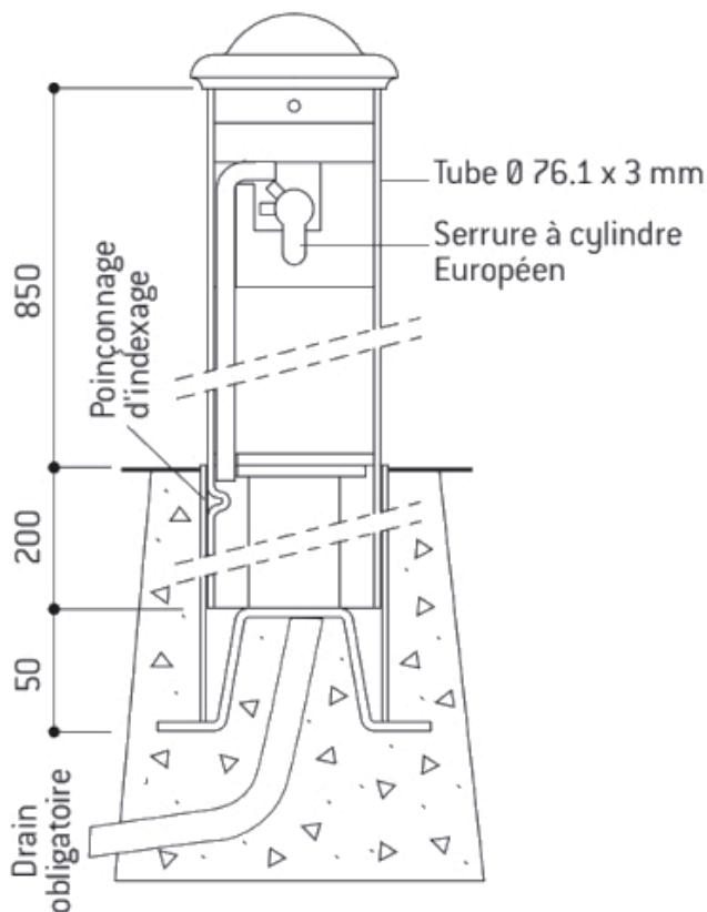
Une fois le fourreau installé, il est très simple d'insérer et d'enlever le potelet.
