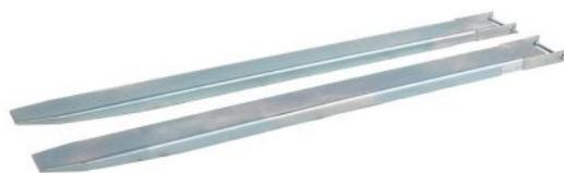
Rallonges fourches pour chariot élévateur en acier galvanisé. Disponible de 1800 mm à 2500 mm de longueur pour une charge maximale d'utilisation comprise entre 2,5 et 7 tonnes selon les modèles.
