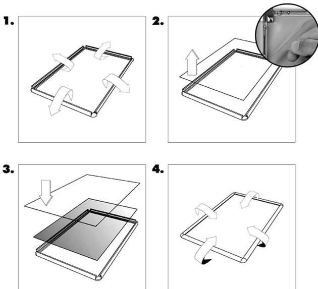
Son installation est également simple. Il suffit d'ouvrir les deux profilés verticaux, de se munir d'une perceuse pour percer 4 trous dans le mur au niveau des 4 trous du cadre et d'y installer 4 chevilles et 4 vis (fournies). Une fois le cadre fixé et l'affiche placée, rabattez les deux profilés.
