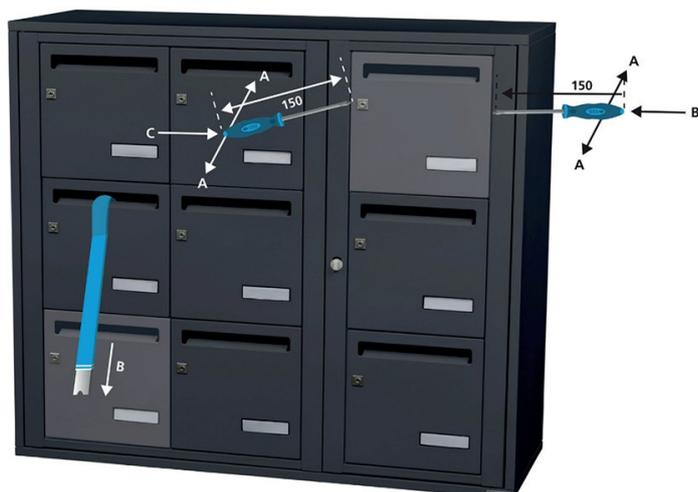
Les boîtes aux lettres collectives doivent résister aux essais d'ouverture en force côté serrure et côté charnière (A), ainsi qu'à l'essai d'arrachement par la fenêtre d'introduction du courrier (B).
