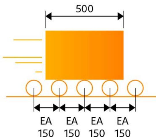
En effet, les produits transportés doivent rester perpétuellement en contact avec au moins 3 rouleaux pour un convoyage optimisé, ce qui guidera votre choix quant au pas à sélectionner : vous avez le choix entre un pas de 60 mm (pour les petits colis avec une taille minimum de 180 mm), et un pas de 150 mm (pour les plus grands colis avec une taille minimum de 450 mm).
