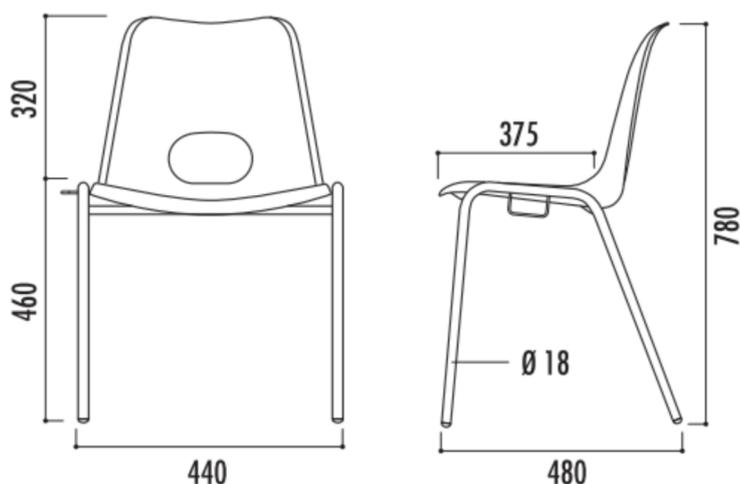
Diamètre des tubes : Ø.18 mm x ép. 1,5 mm
