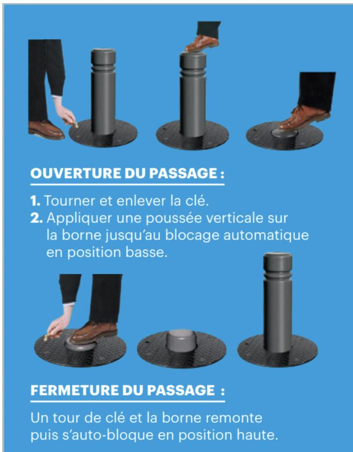
Pour pouvoir installer cette borne rétractable, le plan de maîtrise d'accès ne doit pas laisser les véhicules rouler sur la borne rétractable.
