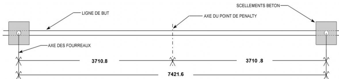
NB: L'ensemble des cotes est exprimé en millimètres
