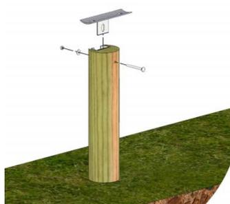
4. Fixer la lisse avec un boulon TRCC 10 x 180 mm et la rondelle M12.
