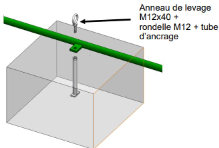
Des contrepoids à lester de sable peuvent également être installés sur la barre arrière du but en fonction de l'option de fixation choisie. Les contrepoids peuvent être utilisés sur toutes les surfaces (pelouse synthétique ou naturelle) et ils restent fixés lors du déplacement du but. Les contrepoids sont résistants à une force verticale de 180 Kg et une force horizontale de 110 Kg.
