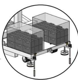
Le but ne doit pas être déplié tant qu'il n'est pas fixé au sol. Les pieds sont réglables pour ajuster la hauteur et pour la stabilité
