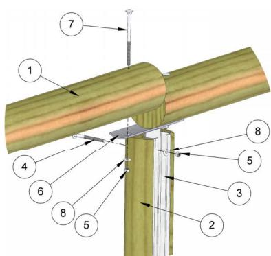
La glissière de sécurité se fixe avec des poteaux scellés dans le sol ou sur platine. L'entraxe entre les poteaux est de 2 mètres. La hauteur hors-sol de la lisse est de 875 mm.
