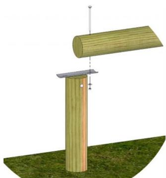
5. Procéder au montage des autres lisses bois et vérifier le serrage de l'ensemble du dispositif.
