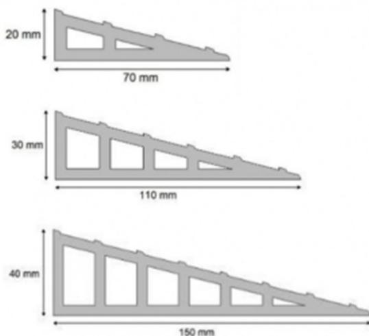
De plus, la rampe d'accès caoutchouc est fabriquée en SEBS (élastomère thermoplastique), une matière ultra-résistante aux intempéries et températures extrêmes (-40° à +120°C).
