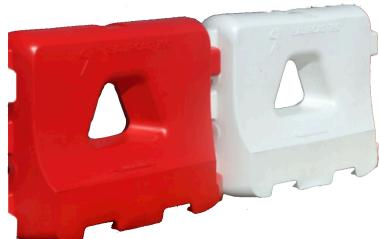
L'installation est simple et rapide. La balise a une emprise au sol de 30 cm, un rayon de courbure inférieur à 3,00 m et est lestable à l'eau avec 50 litres approximativement. La liaison entre les balises est faite par des "ergots" fixes qui font partie de la balise.
