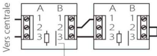
Couper le strap sur le dernier DM en cas de surveillance de ligne ou remplacer le shunt en B2-B3 du dernier DM par la résistance désirée.
