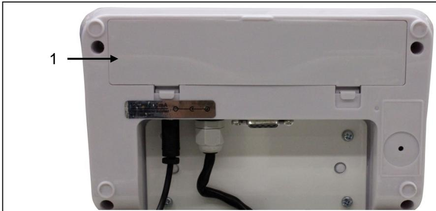
Ouvrir le couvercle (1) du compartiment de pile rechargeable situé au côté inférieur de l'afficheur et brancher la pile rechargeable. Avant la première utilisation, chargez la pile rechargeable pendant 12 heures au moins.
