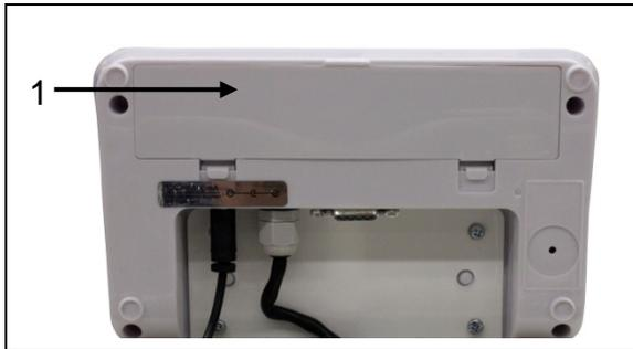
Ouvrir le couvercle (1) du compartiment de pile rechargeable situé au côté inférieur de l'afficheur et brancher la pile rechargeable. Avant la première utilisation, chargez la pile rechargeable pendant 12 heures au moins.
