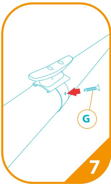
visser la visse autoforeuse dans le trou prévu via la bague
