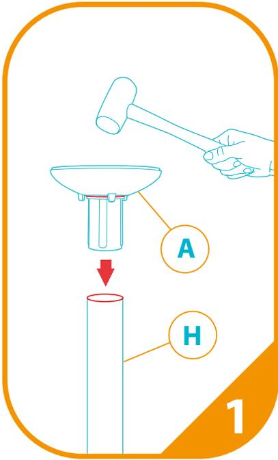
Insérer le pommeau dans le tube jusqu'à la butée à l'aide d'un maillet (non-fourni)
