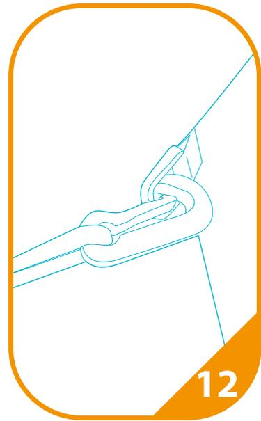
clipser le mousqueton le plus haut à l'anneau situé sur en haut du pavillon idem pour le mousqueton du bas sur l'anneau en bas du pavillon
