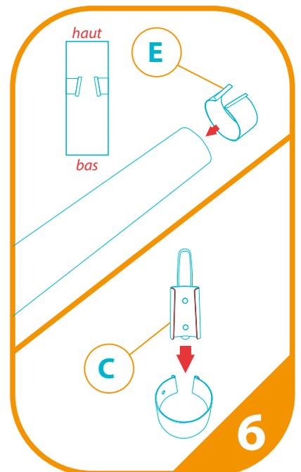
glisser la bague sur le mât selon le sens indiqué à la hauteur où le taquet doit se trouver, puis glisser le taquet sur la bague
