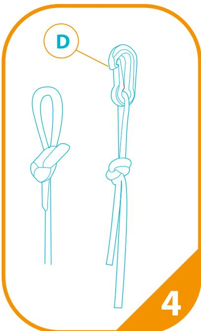
Faire un noeud avec une boucle aux extrémités de la drisse et les passer dans les mousquetons
