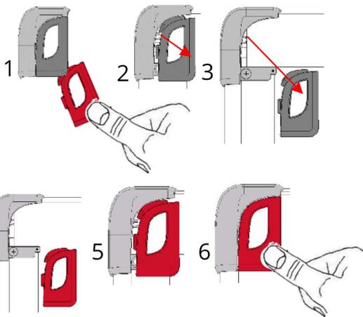
**ATTENTION :** L'assemblage et l'installation de ce produit doivent respecter les instructions ci-jointes et être effectués par une personne compétente.
