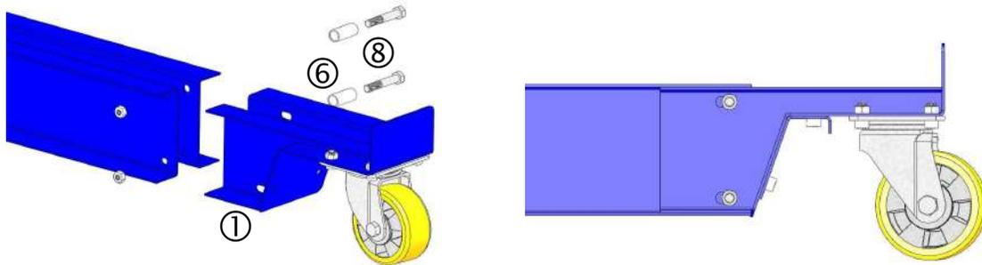
③ Fixer (boulonner) les longerons entre les pieds du rayonnage à l'aide des vis Chc 10 x 20 + ecrous M10.
