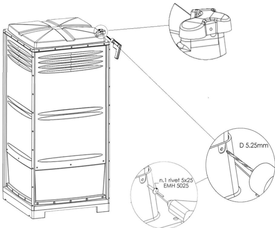
Fixez le bouchon d'aération au toit en utilisant 2 rivets 5x25 mm.
