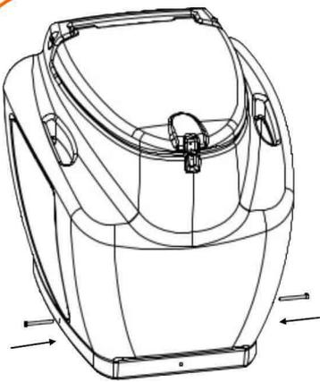
Insérez les deux vis 6x55 mm dans le bas du réservoir à eaux usées.
