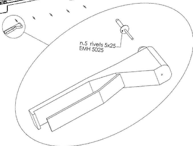
Prenez l'un des panneaux muraux et positionnez le sur l'arrière du socle à poser au sol. Fixez le à l'aide des rivets (5x25mm).
