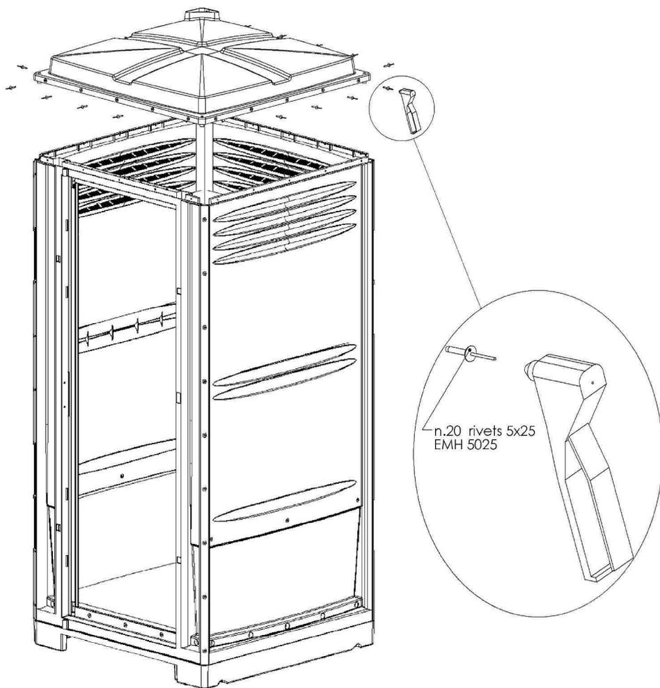
Positionnez le plafond et fixez le avec 20 rivets 5 x 25 mm. Il y a 5 rivets par coté du plafond.
