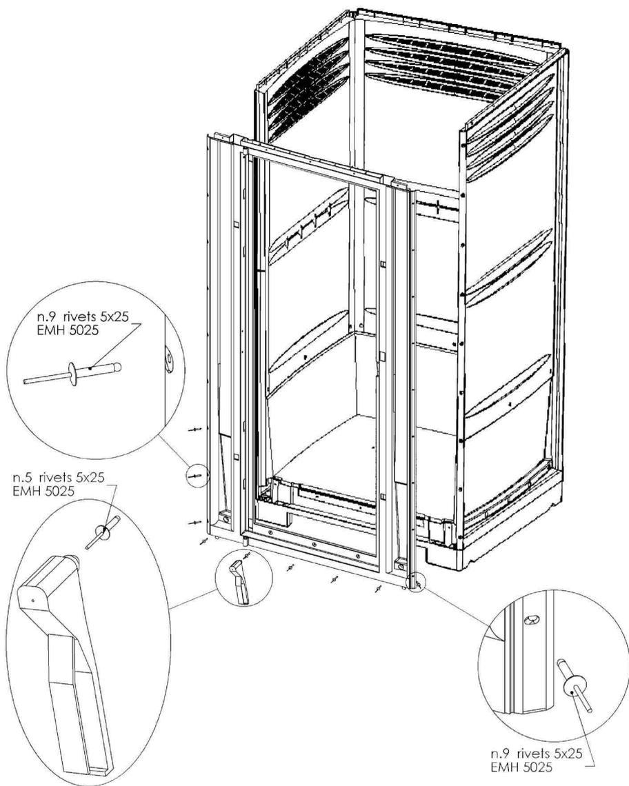
Prenez le cadre de la porte et fixez le aux panneaux muraux latéraux avec les 23 rivets 5 x 25 mm.
