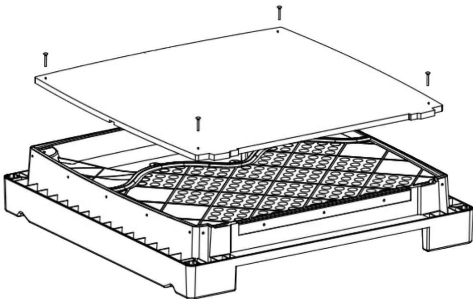
Prenez le sol et fixer le aux 4 coins du socle à poser par terre, à l'aide d'un tournevis et des vis de 4,8 x 38 mm.
