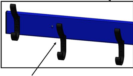
Remarque : il est recommandé de pré-positionner les patères avant de les fixer définitivement, afin de vérifier que ceux-ci n'obstruent pas les perçages faits précédemment sur les lisses.
