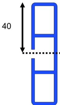
Reprendre les dimensions L1 et L2 choisies lors de la première étape de l'implantation des supports muraux, et percer la lisse de part en part en suivant les instructions du schéma ci-dessous :
