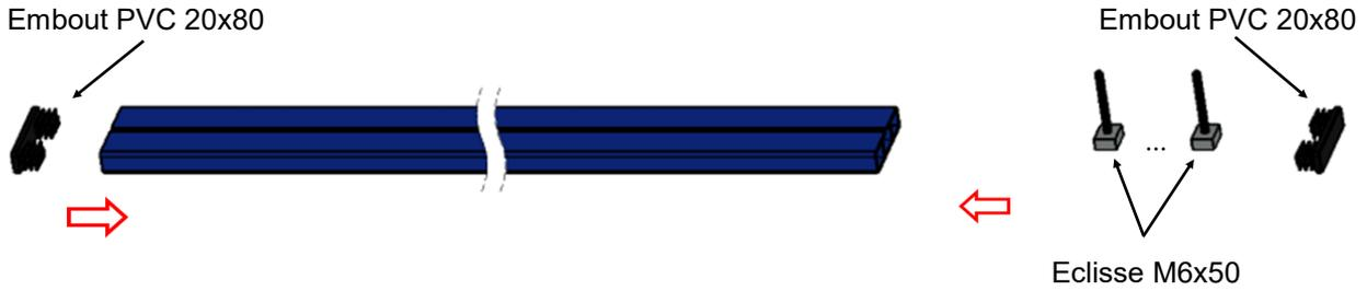
**Insérer les éclisses dans les lisses en prévoyant une éclisse M6x50 par pied**
