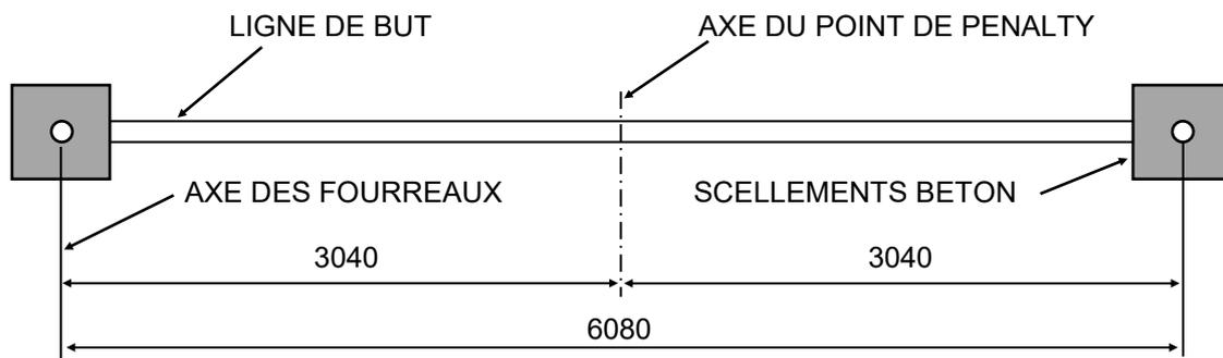
NB : L'ensemble des côtes est exprimé en millimètre
